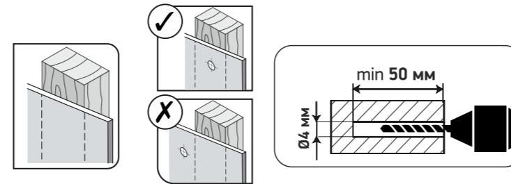
**2.2** Сверление отверстий в бетонной стене:
