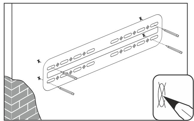
**2.1** Сверление отверстий в деревянной стене:
