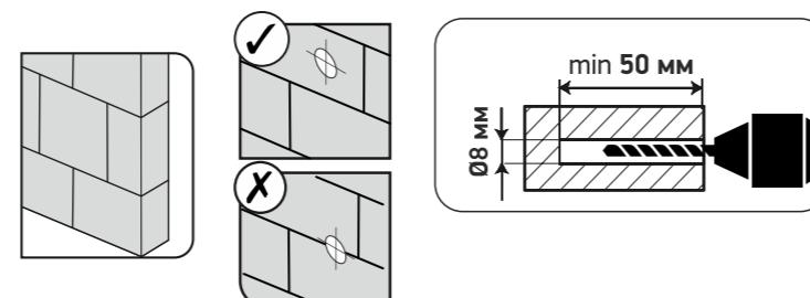
**3** Прикрутите пристенную панель к стене, используя рекомендованный крепеж.
