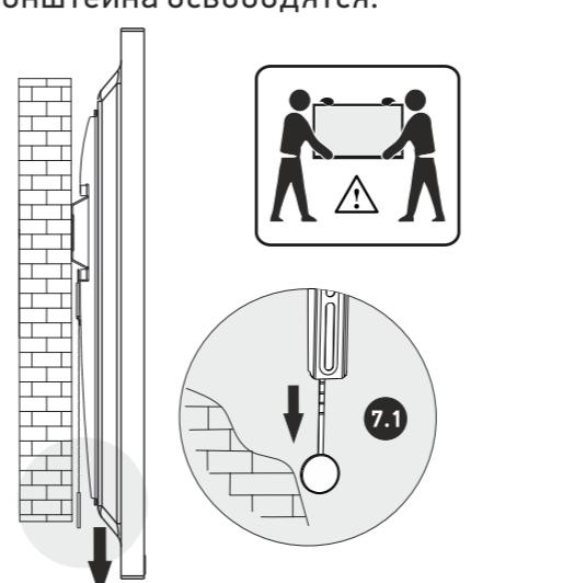
7.2 Отодвиньте нижнюю часть телевизора от стены и приподнимите его.
