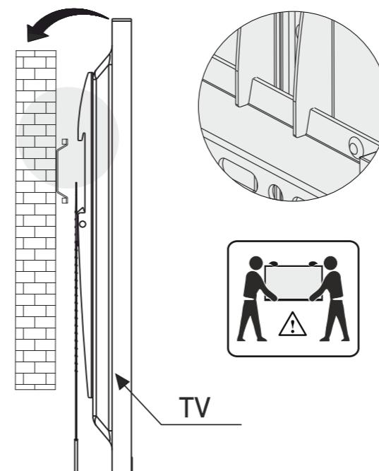
**6.2** Прижмите нижнюю часть телевизора к стене до характерного щелчка фиксатора кронштейна.
