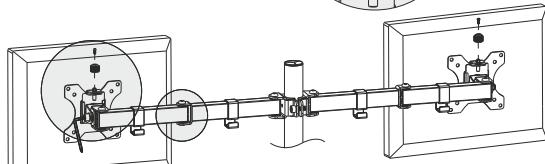
4с. Для регулировки винтов рычажных механизмов на плече кронштейна (B) используйте ключ (M). Мониторы должны быть надежно зафиксированы в любом из выбранных вами положений.
