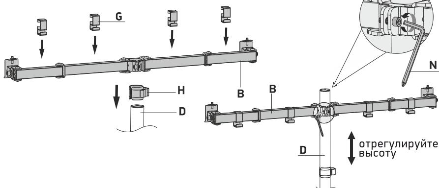
На трубу (D) установите плечо кронштейна (B). Отрегулируйте желаемую высоту и затяните винты с помощью ключа (N).
