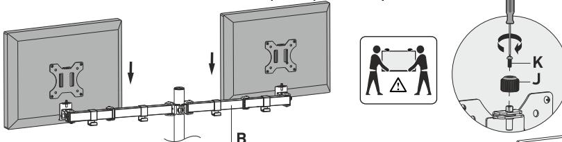
4б. Поверните ключом (N) по часовой стрелке, чтобы затянуть винт после установки мониторов под нужным углом. Перед регулировкой угла наклона немножко ослабьте винт.
